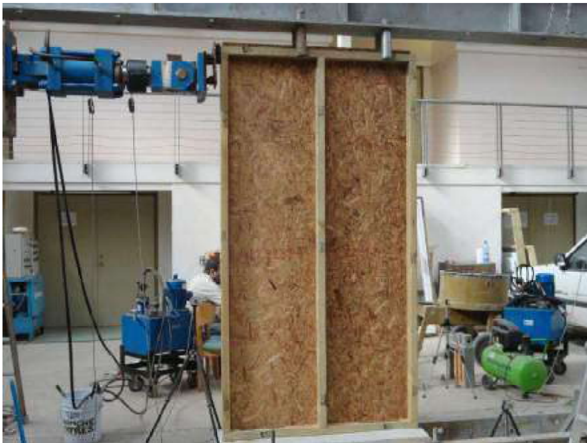
Figura 2.3: Implementación del ensayo de carga horizontal en muros con estructura de madera.
